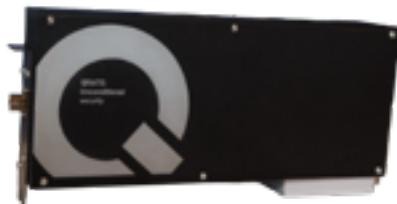
Миниатюрный передатчик для системы квантового распределения ключей (КРК)
