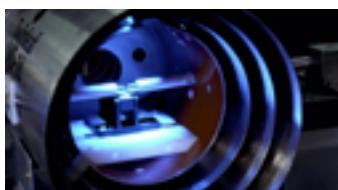
В рамках европейского проекта QMag создан прибор для обнаружения структурных дефектов в конструкционных ферромагнитных материалах на базе квантового магнетометра.
